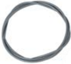
E569P Cabo de aço inox 4mm Plastificado Cabo de aço inox AISI316 com revestimento em PVC. Diâmetro cabo: 4mm. Diâmetro total: 5mm. Metro. Plasticized stainless steel cable 4mm Stainless steel AISI316 cable with PVC coating. Cable diameter: 4mm. Total diameter: 5mm. Meter.
